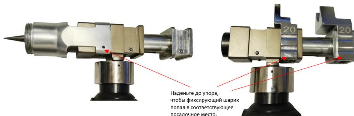
Рис. 1 Правильная установка расширительного адаптера и запрессовочных тисков на аксиальном прессе
